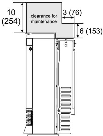
Les dégagements d'accès à l'appareil pour son entretien sont de 10 po (254 mm) sur les côtés, 40 po (1 m) à l'avant, et toute la surface indiquée sur l'illustration de gauche au-dessus de l'appareil.
